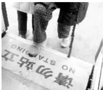
■两级踏步改为低入口一级踏步 ■地板高度也由62厘米降至36厘米 ■踏板为醒目的黄色
